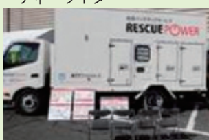
⑰移動電源車 500KVA
