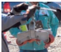
ii) 金車の正しい取付け
