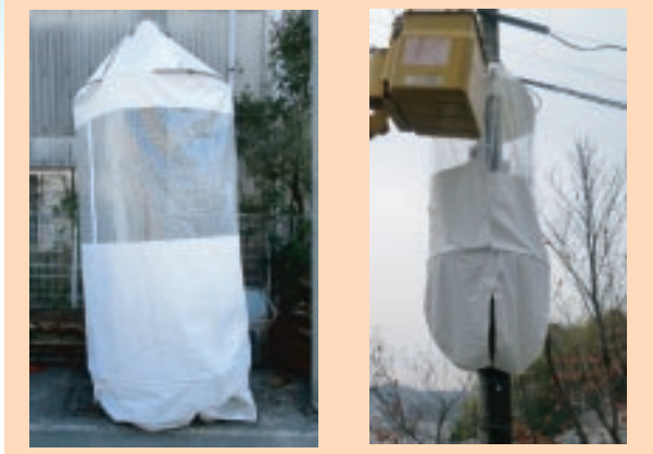
地上1.5～2mで切断の場合 地上3m以上で切断の場合 図8 電柱切断機用飛散防止シート(寸法4,300×4,360mm)
