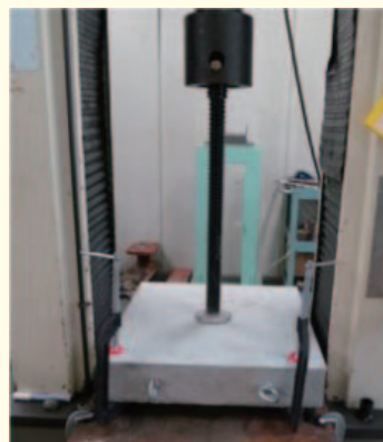
写真 引張り強度試験状況
