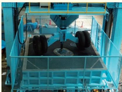
輪荷重試験機
