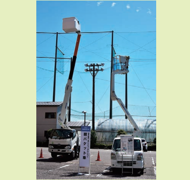
写真30 展示コーナー (アイチコーポレーション) 軽自動車架装式高所作業車
