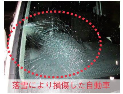
図3 架空設備からの落雪による物損事故の様子
