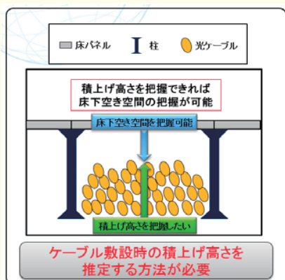
図1 ケーブル積上げ高さ推定
