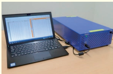
図1 高機能型通信モニタツール(右側)
