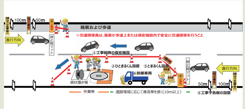
図2 片側道路規制時の保安施設標準パターン
