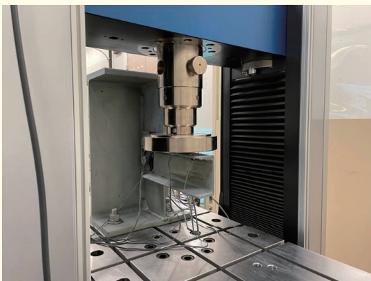
図1 側面添架形式の荷重試験
